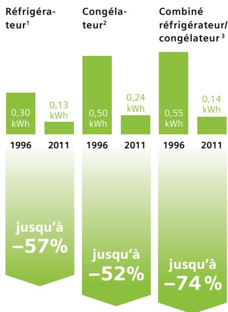
\*Valeurs de consommation avec le programme normal du réfrigérateur KI24RA56FF<sup>(1)</sup>, du congélateur GS40NA22<sup>(2)</sup> et du combiné réfrigérateur/congérateur KG36EAI40<sup>(3)</sup> datant de 2011 comparées aux valeurs de consommation d'appareils Siemens équivalent datant de 1996.
