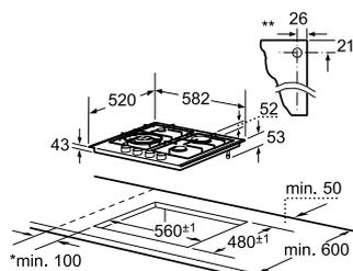
\* Distance minimale entre la découpe de plaque et le mur min. 30†
