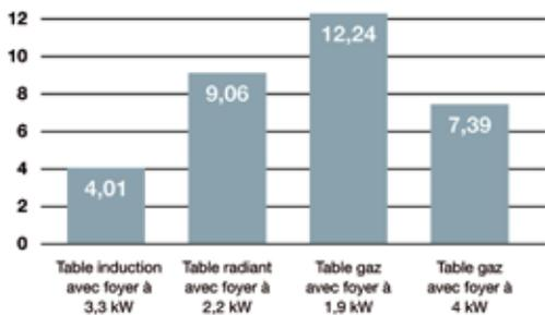
**Énergie utilisée (en kWh.) pour chauffer 2 litres d'eau de 15°C à 90°C.**
