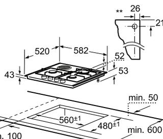
\* Distance minimale entre la découpe de plaque et le mur min. 30†
