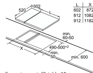
Pour l'encastrement d'1 table 60 cm avec 1 domino côte à côte, l'utilisation d'une barrette de jonction est nécessaire.
