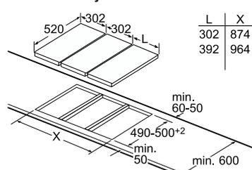
Pour l'encastrement de 2 ou plusieurs dominos côte à côte, l'utilisation d'une, voire plusieurs barrettes de jonction est nécessaire. (2 éléments une barrette de jonction, 3 éléments deux barrettes de jonction, etc...).
