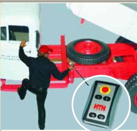
**Für kleine Kipp-Lkw interessant:** HTH liefert Elektro-Hydraulikanlagen, die optional mit Funksteuerung verfügbar sind.
