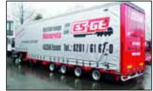
3-6-achsige Satteltieflader in Niedrigbauweise mit Curtainsider-Aufbau, 800 mm Ladehöhe, anheb- und verbreiterbar aus ca. 4600 mm
