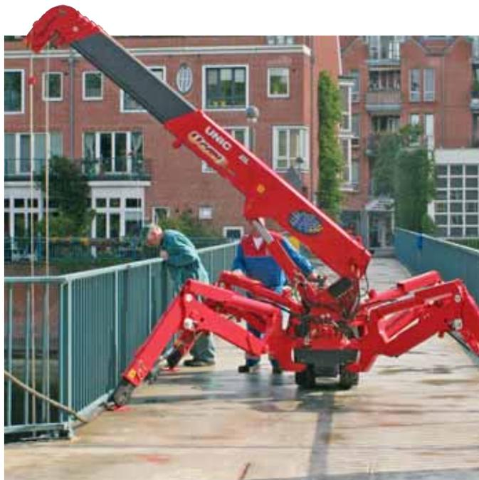
**Direkter Zugang:** Durch das (vergleichsweise) geringe Einsatzgewicht von 1,85 t kann der URW-295 eine Fußgängerbrücke befahren.
