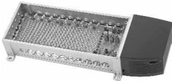
Modernste Chip- und SMD-Technologie zeichnen diesen neuartigen Kanalumsetzer aus. Auf einfache Weise können nun vorhandene Baumnetze mit 2x4 Satelliten-Polarisationen versorgt werden, ohne eine aufwendige Installation einer Sternverkabelung zu jedem Teilnehmer vorzunehmen. Der Umsetzer wird über DiSEqC von jedem Teilnehmer über einen Receiver z.B. SDR 500 U oder SDR 510 U (Seite 3.06) gesteuert. Weitere Highlights:
