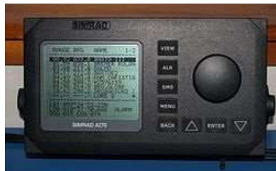
Aluksen AIS:n tekstinäyttö, jossa lista läheisten alusten etäisyyksistä, suuntimista ja nimistä.
