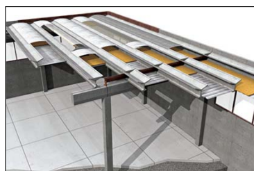
Travi in c.a.p. semplicemente appoggiate (anche su strutture gettate in opera)
