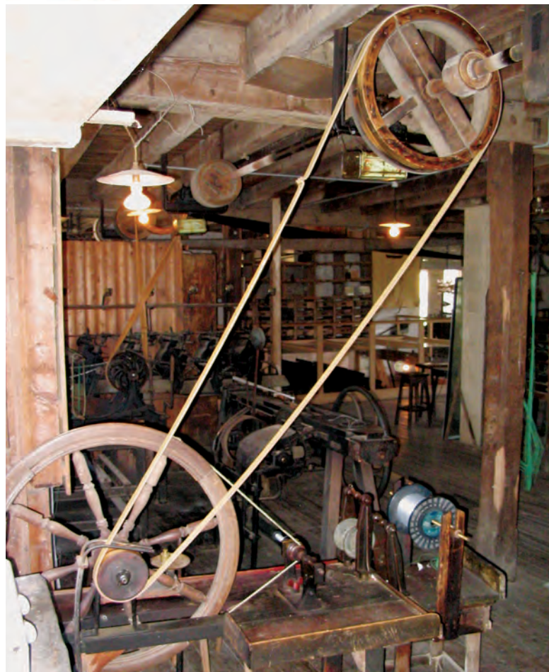
La transmission du mouvement (cliché V. Michelot)
