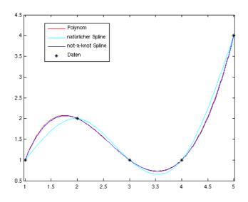
der natürliche Spline läuft an den Rändern geradlinig aus Polynom (4. Ordnung) und not-a-knot-Spline (2x 3. Ordnung) sind kaum zu unterscheiden Reproduktion aller Ergebnisse mit dem Matlab-Skript ex09.m
