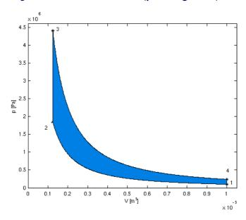
umschlossene Fläche = abgegebene Arbeit W bei einem Umlauf
