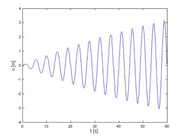
Der Plot zeigt, dass sich die Schwingung der Masse noch aufschaukelt, man muss für die Dauerschwingung also länger simulieren. Für  $t_1 = 600$  s erhält man
