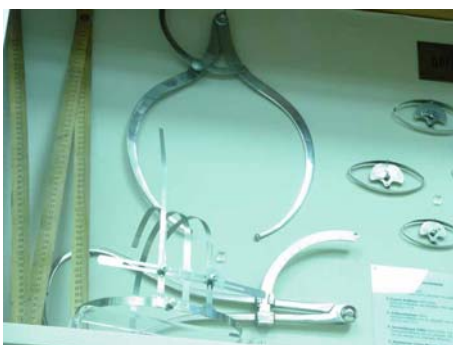
Κυρτοί διαβήτες. Χρησιμοποιήθηκαν για μετρήσεις.
