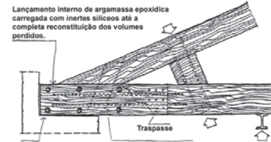
Fig. 16 – Diversas hipóteses de consolidação de tesoura com extremidade degradada
