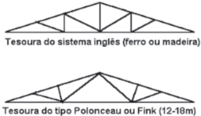
Fig. 12 – Alguns tipos de tesouras. Outros modelos existem como variantes destes apresentados.
