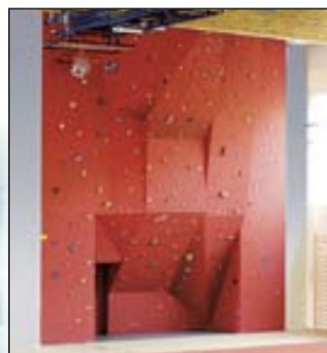
Große Schul-Kletterwand. Breite 11 m, Höhe bis 7 m, Gesamtfläche ca. 105 m 2 , Überhang 2,6 m.
