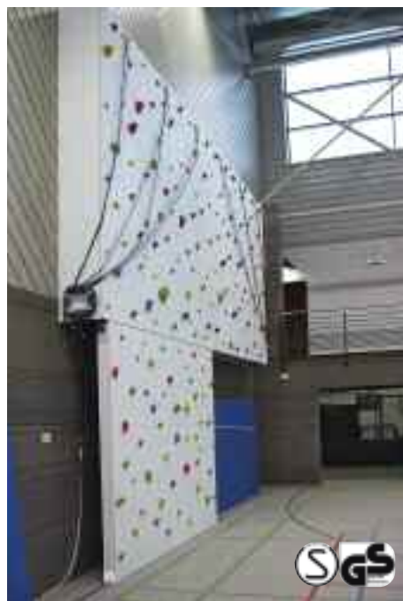
A Abgelassener Einstiegsbereich, bündig abschließende Oberfläche von Ober- und Unterteil.
