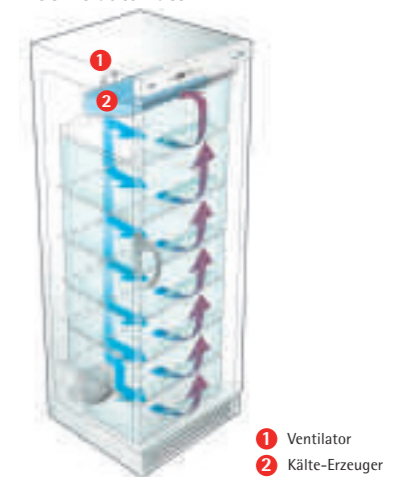
Luftzirkulation in den Stand-Gefrierautomaten
