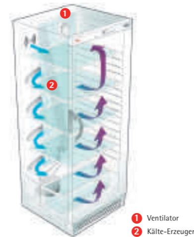
Luftzirkulation in den Stand-Kühlautomaten
