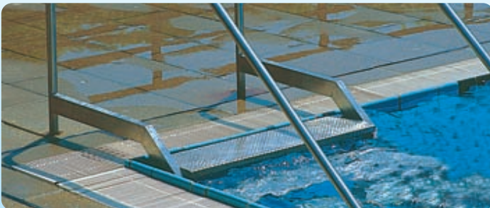
Einsteigtreppe starre Ausführung, aus starkwandigem poliertem V2A-Edelstahl. Handlauf aus Rundrohr Durchm. 40 mm, Trittfläche der Stufen aus genopptem, rutschfestem Edelstahl. Treppenbreite 100 cm. 15752 Preis auf Anfrage
