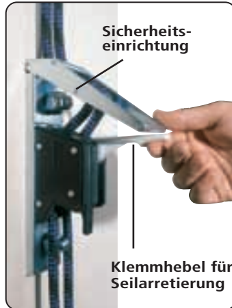
Öffnen des Klemmhebels für Seilarretierung nur bei entlastetem Seil möglich.
