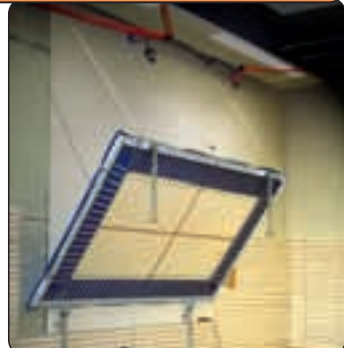
Trampolinanlage beim Hochfahren zur Wand mittels elektrischem Motorantrieb. Die Füße klappen automatisch aus/ein.
