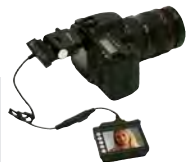
Verwendung des ZigViews S2 mit Videokabel und externer Auslösung
