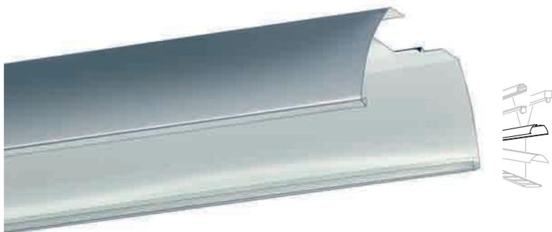
Reflektor für VLSG-T16 ein- und zweilampig. Profilerter Reflektor aus verzinktem, außen silber, innen weiß kunstharzbeschichtetem Stahlblech. Gute Reflexionseigenschaften und tiefbreitstrahlende Lichtstärkeverteilung. Einschließlich Reflektorverbinder.
