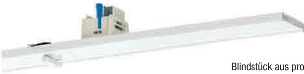
Blindstück aus profiliertem Stahlblech, kann anstelle eines Geräteträgers montiert werden. An der Blindabdeckung können Reflektoren montiert werden. Drehriegelverschluss wie beim Geräteträger. Incl. Dichtungen. Schutzart IP54.
