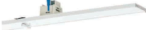
Blindstück aus profiliertem Stahlblech, kann anstelle eines Geräteträgers montiert werden. An der Blindabdeckung können Reflektoren montiert werden. Drehriegelverschluss wie beim Geräteträger. Incl. Dichtungen. Schutzart IP54.
