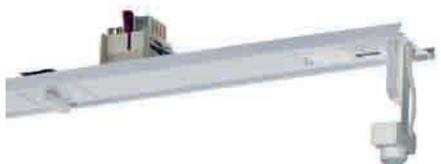
Geräteträger mit Bewegungsmelder. Farbcodierung lila zur Montage in VLT-T16-7 oder VLT-T16-11. Bewegungsmelder steuert direkt das EVG an. Jeder Geräteträger arbeitet für sich autark. Über die Steuerleitung können die Geräteträger überwacht werden (Funktion Lampe / EVG). Ebenso ist das Schalten des gesamten Lichtbandes unabhängig vom Bewegungsmelder möglich. Das Schaltprofil kann nachträglich in der bestehenden Anlage über die Steuerleitung umprogrammiert werden.
