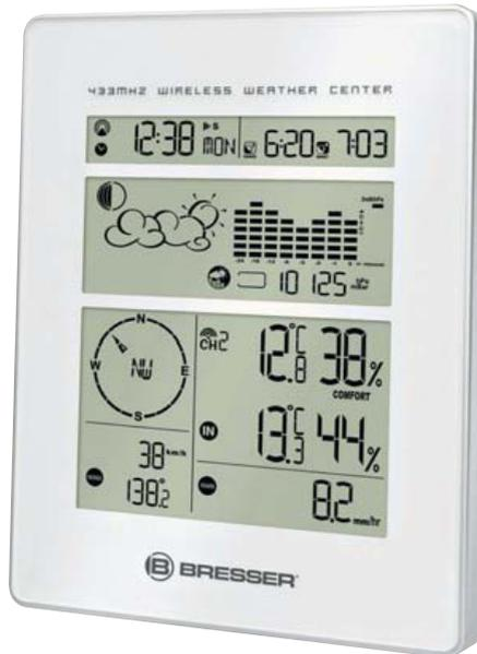
**Technische Daten:** Innentemperatur: 0 bis +50 °C · Außentemperatur: -20 bis +60 °C · Innenluftfeuchte: 0 bis 99 % · Außenluftfeuchte: 0 bis 99 % · Luftdruck: 500 bis 1100 mbar · Windgeschwindigkeit: 0 bis 199 km/h · Niederschlag: 0 bis 1999,9 mm · Genauigkeit Luftfeuchte: ±5 % · Messintervall: 33 bis 183 s · Funkfrequenz: 433 MHz · Max. Reichweite: 100 m · Max. Anzahl Sensoren: 5 · Gewicht (Regensensor): 290 g · Spannungsversorgung Station: Mignon-
