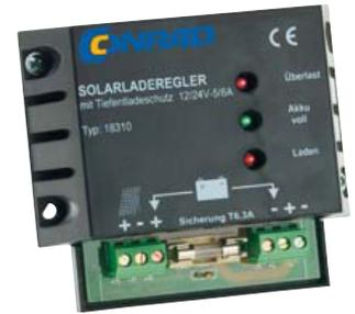
nung: 13,8 V · Rücksetz-Spannung: 12,5 V · Tiefentladeschutz: Für 12 und 24 V-Anlagen · Tiefentlade-Abschaltspannung: 11,1/22,2 V · Kabelquerschnitt: 1,5 mm<sup>2</sup> · Abm.: (L x B x H) 98 x 88 x 35 mm.
