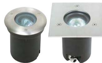
**Technische Daten:** Betriebsspannung: 12 V · Sockel: GU5.3 · Leuchtmittel-Typ: MR16 Halogenleuchtmittel · Leistung: Max. 35 W · Schwenkbereich: 30 ° · Drehbereich: 90 ° · Schutzart: IP67 · Schutzklasse: III · Belastbarkeit: 5 t · Farbe: Edelstahl · Material: Aluminium · Einbau-Tiefe: 120 mm · Einbau-Ø: 120 mm.
