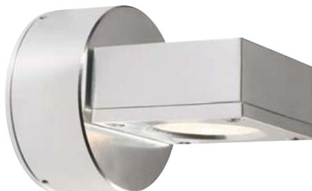
**Technische Daten:** Betriebsspannung: 230 V/50 Hz · Sockel: LED fest eingebaut · Leuchtmittel-Typ: LED · Leuchtfarbe: Warm-Weiß · Leistung: 6 W · Schutzart: IP54 · Schutzklasse: I · Farbe: Aluminium · Abm.: (L x B) 69 mm x 69 mm.
