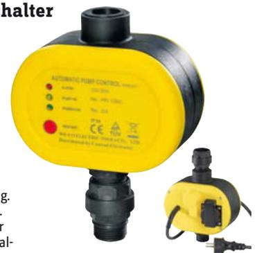
Druckschalter zur Steuerung der Pumpe für die Hauswasserversorgung. Dieser erkennt den Druck-Abfall bzw. Anstieg in der Leitung beim Auf- oder Abdrehen des Wasserhahns und schaltet die Pumpe automatisch ein bzw. aus.
