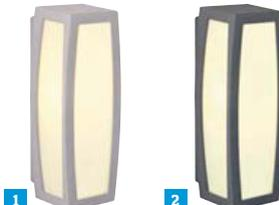
**Technische Daten:** Betriebsspannung: 230 V/50 Hz · Sockel: E27 · Leuchtmittel-Typ: Energiesparlampe · Leistung: Max. 25 W · Schutzart: IP54 · Schutzklasse: I · Material: Aluminium/Kunststoff · Abm.: (L x B x H) 370 x 130 x 140 mm.
