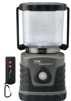
**Technische Daten:** LEDs: 4 · Material: Stoßfester Kunststoff · Leuchtmittel-Typ: 4 Nichia Hochleistungs-LED · Gewicht: 1765 g (inkl. Batterien) · Lichtstrom: 300 lm · Farbe: Grau · Abm.: (B x H x T) 122 x 240 x 122 mm · Leuchtdauer: High > 100 h · Low > 350 h · SOS-Flashing 400 h · Batterien: Laternen: 6 Mono-Batterien (bitte separat bestellen) Fernbedienung: 2 Micro-Batterien (inkl.)
