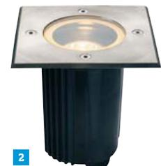
**Technische Daten:** Betriebsspannung: 230 V/50 Hz · Sockel: GU10 · Leuchtmittel-Typ: Halogenleuchtmittel · Leistung: max. 35 W · Schutzart: IP67 · Schutzklasse: I · Schwenkbereich: 30° · Drehbereich: 90° · Belastbarkeit: 2 t · Farbe: Aluminium · Material: Edelstahl
