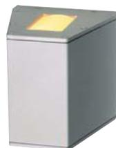
**Technische Daten:** Betriebsspannung: 230 V/50 Hz · Schutzklasse: I · Leuchtmittel-Typ: HV-Halogen · Sockel: R7s, 78 mm · Leistung: Max. 150 W · Schutzart: IP44 · Abm.: (B x H x T) 150 x 150 x 155 mm.
