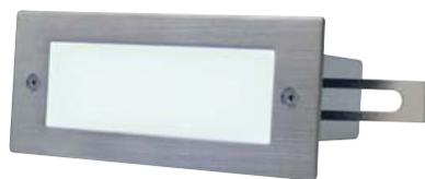
**Technische Daten:** Betriebsspannung: 230 V/50 Hz · Leuchtmittel-Typ: 16 LEDs · Leistung: 1 W · Schutzart: IP44 · Schutzklasse: I · Farbe: Edelstahl · Einbau-Breite: 160 mm · Einbau-Länge: 56 mm · Einbau-Tiefe: 90 mm · Abm.: (B x H x T) 170 x 68 x 80 mm.
