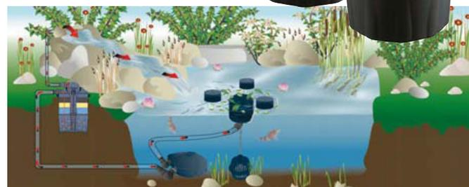
Die Wirkung des Filters ist mechanisch, biologisch und mit UV-Bestrahlung. Das unter Druck stehende Wasser kann nach dem Auslauf einen Wasserfall speisen und für eine bessere Sauerstoffanreicherung in Ihrem Teich sorgen. Außerdem befindet sich
