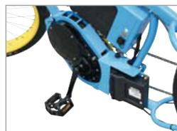
Hybrid Motor, Clean Mobile, Motorleistung 1,2 kW / 150 Nm
