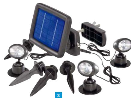
**Technische Daten:** Leuchtfarbe: Weiß · Leuchtdauer: Bei vollem Akku max. 8 h · Akku: 3x 1,2 V Mignon (900 mAh) · Farbe: Schwarz · Schutzart: IP44 · Leuchtmittel-Typ: LED · Abm.: (L x B x H) 145 x 105 x 28 mm.
