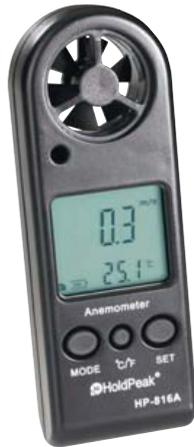
**Technische Daten:** Windgeschwindigkeit: 0 bis 90 km/h, 0 bis 30 m/s, 0 bis 55 Knoten, 0 bis 65 MPH, 0 bis 5860 ft/min · Genauigkeit: ±5 % · Spannungsversorgung Station: CR 2032 Knopfzelle (inkl.) · Abm.: (B x H x T) 40 x 141 x 19 mm · Gewicht: 50 g.
