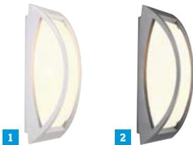
**Technische Daten:** Betriebsspannung: 230 V/50 Hz · Sockel: E27 · Leuchtmittel-Typ: Glühlampe · Energiesparlampe · Leistung: Max. 60 W · Schutzart: IP54 · Schutzklasse: I · Material: Aluminium · Abm.: (B x H x T) 140 x 380 x 145 mm.
