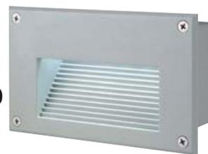
**Technische Daten:** Betriebsspannung: 230 V/50 Hz · Leuchtmittel-Typ: LED · Leistung: 3,6 W · Schutzart: IP54 · Schutzklasse: I · Farbe: Silber-Grau · Einbau-Breite: 100 mm · Einbau-Länge: 160 mm · Einbau-Tiefe: 75 mm · Abm.: (B x H x T) 170 x 105 x 70 mm.
