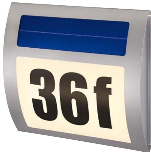
Bei Tag werden die eingebauten Akkus durch das hochwertige kristalline Solarmodul geladen. Bei Nacht schalten sich die eingebauten 5 weißen Leuchtdioden automatisch ein und sorgen für schattenfreie Beleuchtung der Hausnummer. Um auch bei schlechter Sonneneinstrahlung oder dunkler Jahreszeit eine möglichst lange Leuchtdauer zu erreichen wird bei sinkender Batteriespannung die Leuchtstärke automatisch reduziert.
