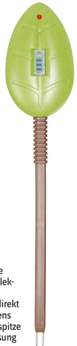
**Hinweis:** Beachten Sie bitte, dass die Anzeige aufgrund der Messung der elektrischen Leitfähigkeit des Erdbodens beruht. Wenn die Sensorspitze z.B. direkt im Wasser steckt, so werden höchstens 2 oder 3 Balken angezeigt. Die Messspitze muss deshalb für eine korrekte Messung in der Erde stecken!
