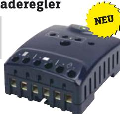
Der Laderegler schützt die Batterie vor Über- und Tiefentladung. Die Ladekennlinien beinhalten mehrere Schritte zu denen die automatische Anpassung als auch die Messung der Umgebungstemperatur gehören. Eine Sperrdiode verhindert den Rückfluss der Energie.
