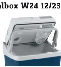
**Technische Daten:** Gewicht: 5,5 kg · Kühlbereich: Kühlen max. 18 °C unter Umgebungstemperatur · Heizen max. 65 °C · Betriebsspannung: 12/230 V · Nutzinhalt gesamt: 24 l · Abm.: (L x B x H) 390 x 420 x 310 mm.
