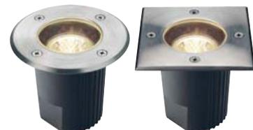
**Technische Daten:** Betriebsspannung: 12 V · Sockel: GU5.3 · Leuchtmittel-Typ: MR16 Halogenleuchtmittel · Leistung: 35 W · Schutzart: IP67 · Schutzklasse: III · Farbe: Edelstahl · Einbau-Tiefe: 145 mm · Einbau-Ø: 130 mm.
