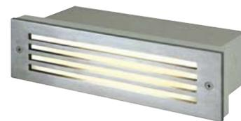
**Technische Daten:** Betriebsspannung: 230 V/50 Hz · Sockel: G23 · Leistung: 9 W · Schutzart: IP54 · Schutzklasse: I · Farbe: Edelstahl · Einbau-Breite: 75 mm · Einbau-Länge: 257 mm · Einbau-Tiefe: 95 mm · Abm.: (B x H x T) 76 x 260 x 90 mm.
