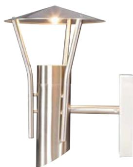
**Technische Daten:** Betriebsspannung: 230 V/50 Hz · Sockel: GU10 · Leuchtmittel-Typ: HV-Halogen · Leistung: Max. 35 W · Farbe: Edelstahl · Schutzart: IP44 · Abm.: (L x B x H) 215 x 175 x 300
