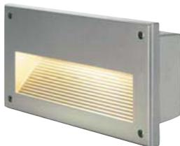
**Technische Daten:** Betriebsspannung: 230 V/50 Hz · Sockel: E14 · Leuchtmittel-Typ: Kerzenlampe · Leistung: Max. 40 W · Schutzart: IP44 · Schutzklasse: I · Einbau-Tiefe: 65 mm · Einbau-Breite: 97 mm · Einbau-Länge: 198 mm · Farbe: Silber-Grau · Abm.: (B x H x T) 227 x 125 x 85 mm.
