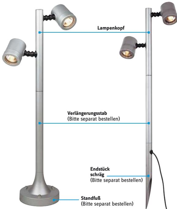
**Technische Daten:** Betriebsspannung: 230 V/50 Hz · Sockel: GU10 · Leuchtmittel-Typ: HV-Halogen · Leistung: 2 x 50 W · Schutzart: IP44 · Schutzklasse: II · Farbe: Silber-Grau · Abm.: (B x H) 70 mm x 305 mm · Material: Aluminium.
