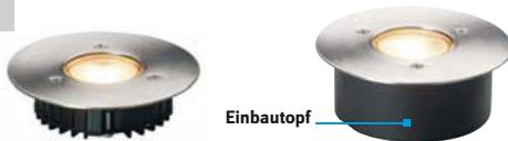
**Technische Daten:** Betriebsspannung: 12 V · Sockel: G4 · Leuchtmittel-Typ: Stiftsockel · Leistung: Max. 20 W · Schutzart: IP67 · Schutzklasse: III · Farbe: Edelstahl · Einbau-Tiefe: 50 mm · Einbau-Ø: 125 mm · Abm.: (Ø x H) 135 mm x 50 mm.
