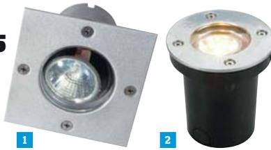
**Technische Daten:** Betriebsspannung: 12 V · Sockel: GU5.3 · Leuchtmittel-Typ: MR 16 · Leistung: Max. 35 W · Schwenkbereich: 20 ° · Belastbarkeit: 0,5 t · Schutzart: IP67 · Schutzklasse: III · Einbau-Tiefe: 112 mm · Einbau-Ø: 105 mm · Farbe: Silber-Grau.
