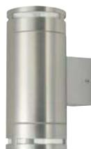
**Technische Daten:** Betriebsspannung: 230 V/50 Hz · Sockel: GX53 · Leuchtmittel-Typ: Energiesparlampe · Leistung: Max. 2 x 9 W · Farbe: Aluminium · Schutzart: IP44 · Schutzklasse: I · Abm.: (L x B) 139 mm x 89 mm.
