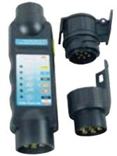
Testet Beleuchtungsfunktionen an Fahrzeug-Anhängerdosen und -Steckern und zeigt die jeweilige defekte Kabelfarbe. Es prüft alle 7poligen Dosen und Stecker und über die zwei mitgelieferten Adapter alle 13poligen in 7poliger Funktion. Stromaufnahme über 9 V Blockbatterie (bitte separat bestellen).
