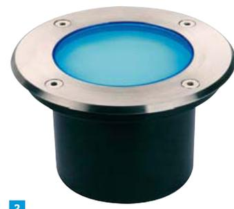
**Technische Daten:** Betriebsspannung: 12 V · Leuchtmittel-Typ: 44 LEDs · Leistung: Ges, 6 W · Schutzart: IP67 · Schutzklasse: III · Belastbarkeit: 2 t · Kabel-Ø: 9 - 13 mm · Material: Alu/Edelstahl · Einbau-Ø: 165 mm · Einbau-Tiefe: 80 mm · Abm.: (Ø x H) 130 mm x 85 mm.
