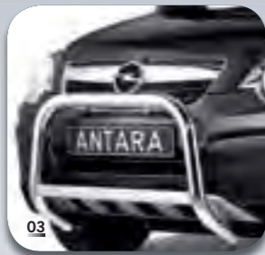
03 Frontbügel, RDG Antara 07-, (nicht für Fahrzeuge mit „Parkpilot“ vorn), Ø 60 mm, Edelstahl verchromt Eintragungsfrei mit EG-Typgenehmigung Art.: FB-311081EC € 539,00
