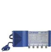
Für den Einsatz in kleineren und mittleren GA-Anlagen, selektive Bereichseingänge, über den Ausgang fernspeisbar (zus. Netzteil SN 15/500), Anschlussart F-Connector
