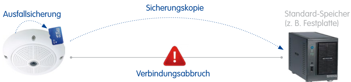
MOBOTIX-Systeme arbeiten dezentral und sicher auch ohne Aufzeichnungs-PC
