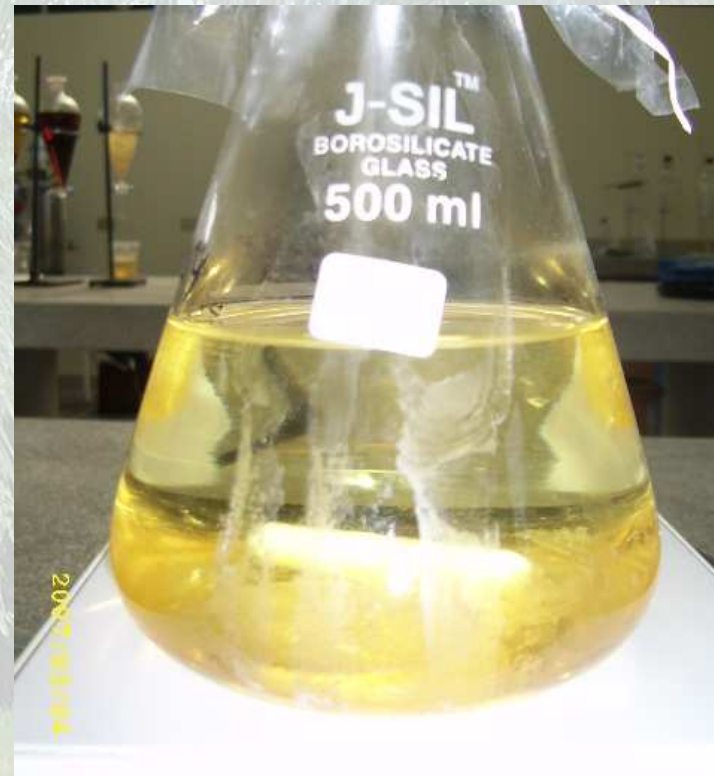
Se calienta a 50 °C para que este en estado líquido y así poder procesarlo
