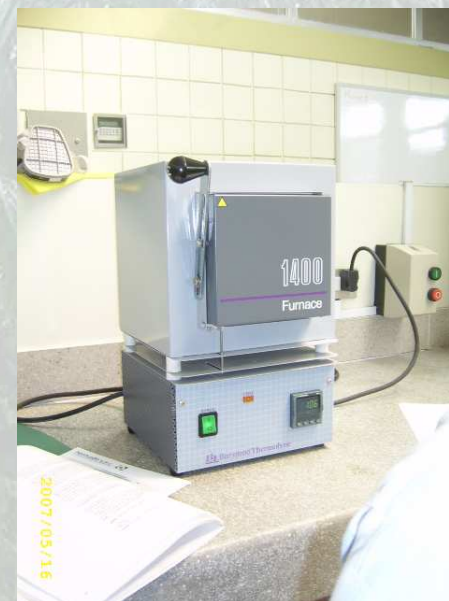
MUFLA : PARA LA DETERMINACION DE CENIZAS SULFATADAS
