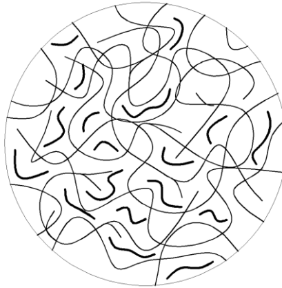
13. ábra A PVC lágyítása
