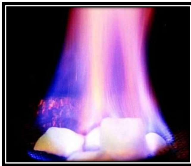
Fig. 2.10. Hidrato de metano, similar al hielo pero con la particularidad de que es flamable debido al gas contenido en su estructura. 9
