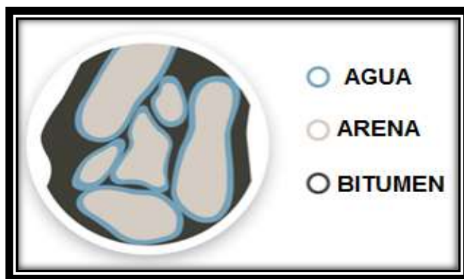
Fig.2.1. Esquema de los distintos componentes de las arenas bituminosas. 1
