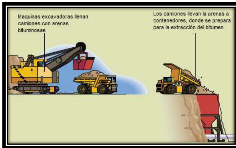
Fig. 2.2. Proceso de minado de las arenas bituminosas encontradas a poca profundidad. 2
