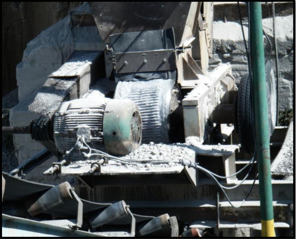
Figura 31. Molino de rodillos con exceso de desgaste
