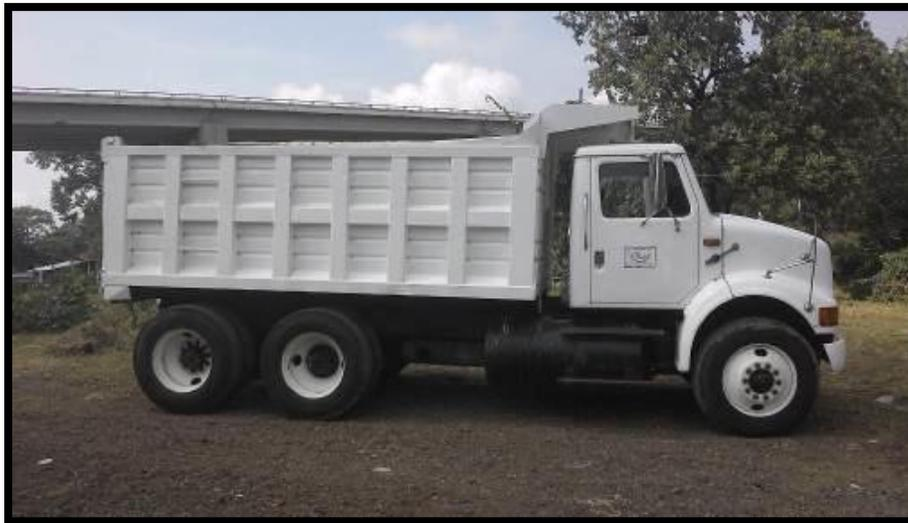
Figura 36. Camión torton de 14 m<sup>3</sup>
