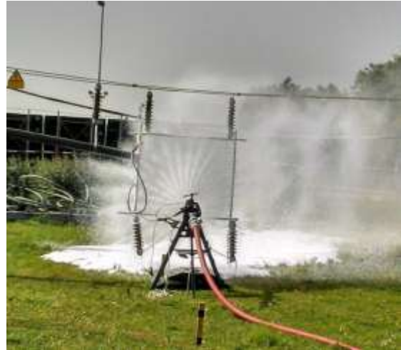
Bild 4-18: Messung von Ableitströmen, Löschen mit Schaum unter Sprühstrahleinstellung. Versuche auf dem Gelände der OVAG in 2014
