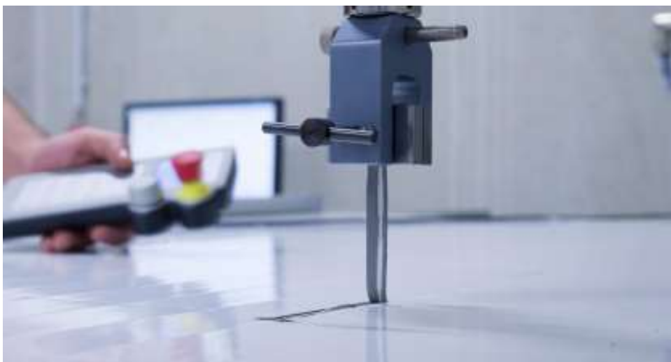
Bild 5-16: Teststand zur Prüfung der Abzugskraft
