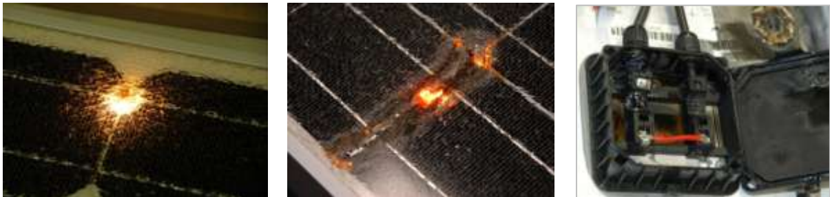
Bild 3-6: Lichtbögen in PV-Modulen, Fotos: TÜV Rheinland
