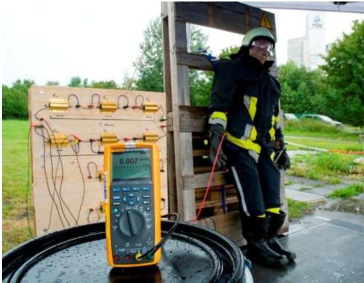
Bild 4-19: Versuchsaufbau mit Dummy und Schematisches Schaltbild
