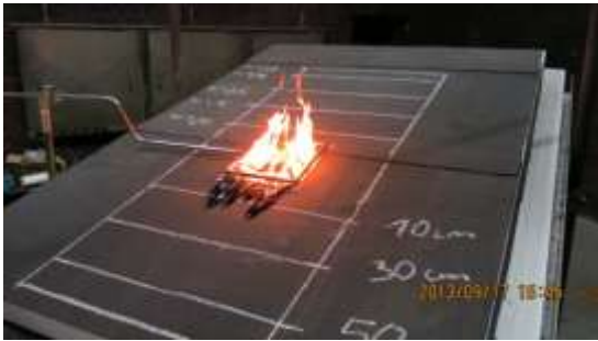
Bild 5-30: Links: Elastomerbitumenunterlagsbahn, EPS-Dämmplatten, Bitumendampfsperrbahn mit neuem Gasbrenner. Rechts: PVC-Dachabdichtungsbahn, Steinwolle Dämmplatten, Bitumendampfsperrbahn
