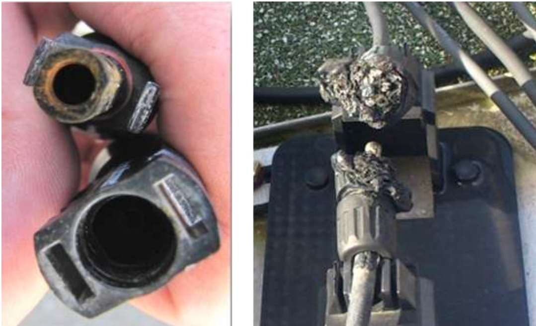
Bild 3-48: Ergebnis der Paarung von Steckverbindern unterschiedlicher Hersteller [33]
