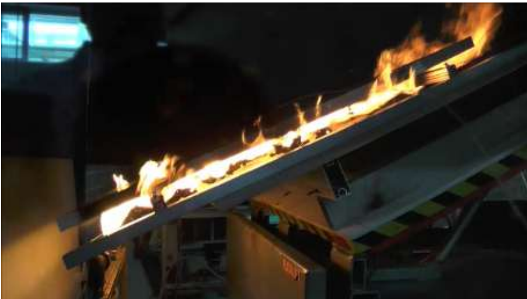
Bild 4-36: Brandversuch mit einer Brennerleistung von 25 kW (oben) und 150 kW (unten)
