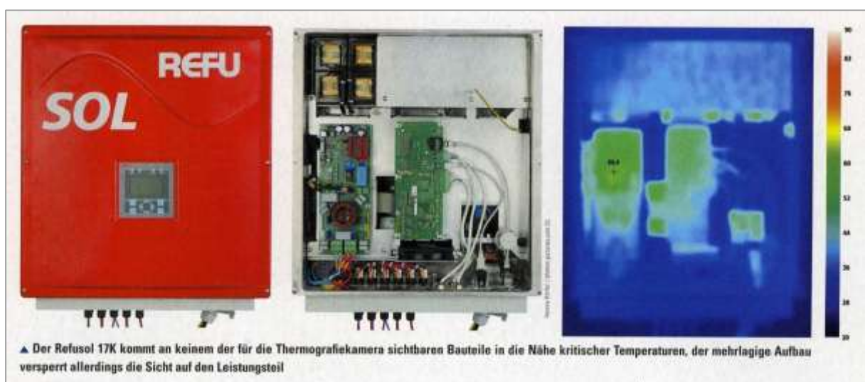
Bild 3-56: Aufbau und Thermografie eines hocheffizienten PV-Wechselrichters. Maximal gemessene Temperatur: 60,4 °C [38]
