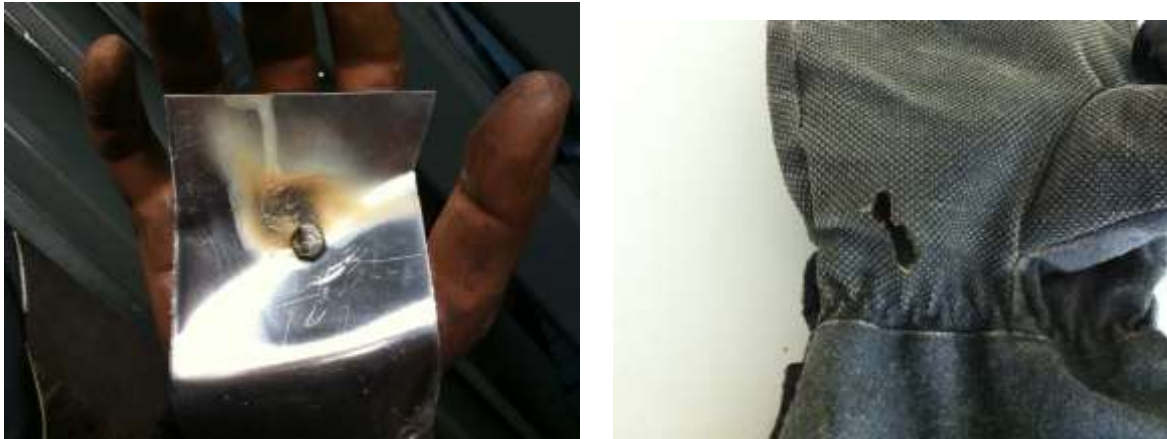
Bild 4-20: Einwirkung der Ströme auf die Kontaktflächen, Brandloch durch Stromeinwirkung
