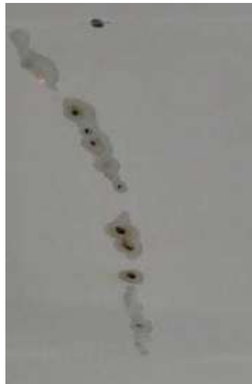
Bild 5-6: Spuren entlang des Zellrisses infolge von Verschmorungen und Lichtblitzen
