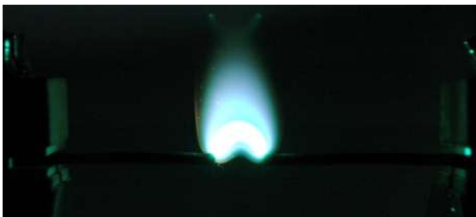
Bild 2-1: Stabiler DC-Lichtbogen zwischen Kupferelektroden, Foto: TÜV Rheinland
