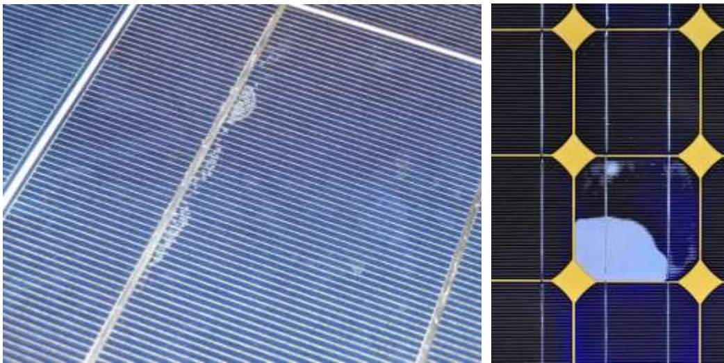
Bild 5-19: Beispiel: Delamination nahe eines Bus-Bars.
