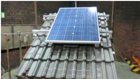
Bild 5-31: Links: Dachparalleler Aufbau mit Betondachsteinen und PV-Modul. Rechts: Zündinitial wurde zwischen Modul und Dachoberfläche platziert
