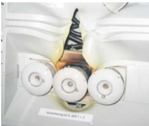
Bild 3-30: Heiß gewordener Sicherungseinsatz (Foto: H. Godard, Energossa)
