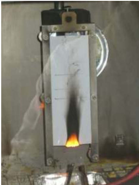
Bild 5-12: Prüfmethode zur Entflammbarkeit nach EN 13501-1
