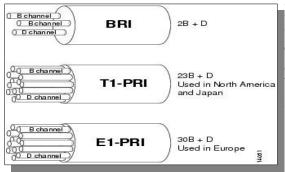
El acceso básico consiste en dos canales B full-duplex de 64 Kb/s y un canal D full-duplex de 16 Kb/s. Luego, la división en tramas, la sincronización, y otros bits adicionales dan una velocidad total a un punto de acceso básico de 192 Kb/s (2B + D + señalización + sincronización + mantenimiento).
