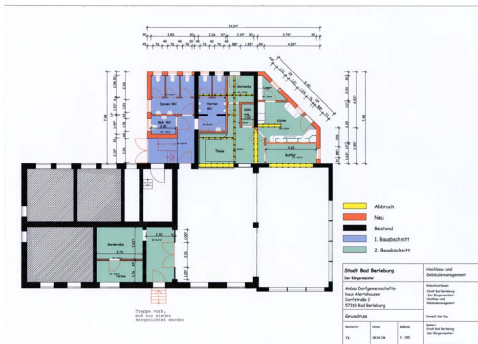
Abb. 52: Grundriss geplanter Umbau DGH Alertshausen
