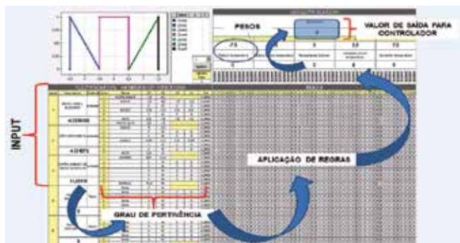
Figura 7. Princípio de operação do DME
