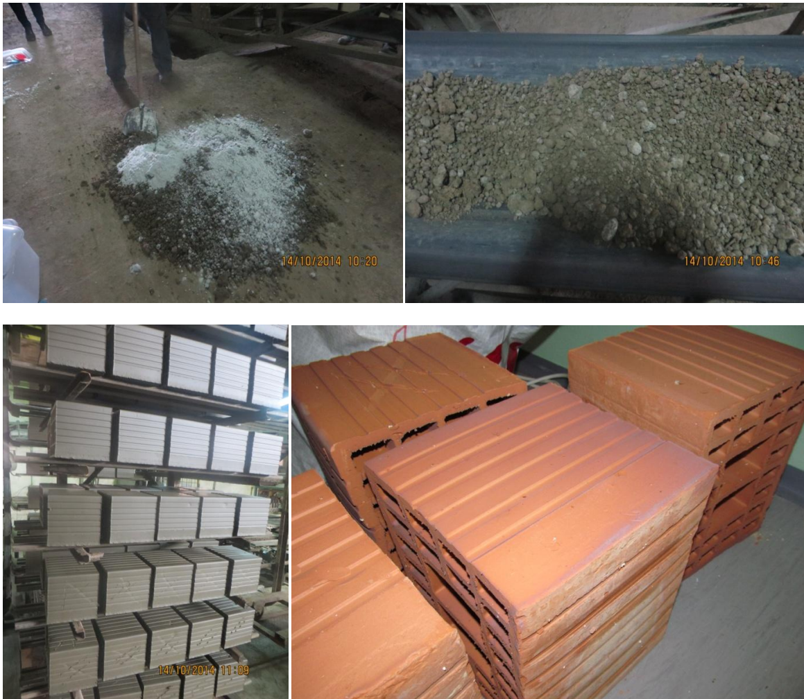
Слика 5- Процес производње блока са стакленим рециклатом
