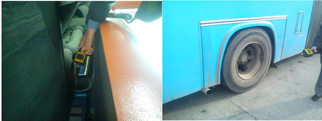
Слика 1: Мерење испарљивих органских материја издувних гасова а) непосредно на месту испуштања б) удаљност 30 цм
