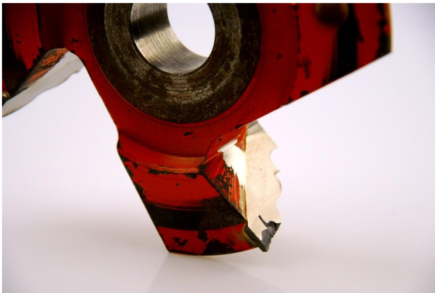
Слика 3. Фотографија оштећеног сечива глодала
