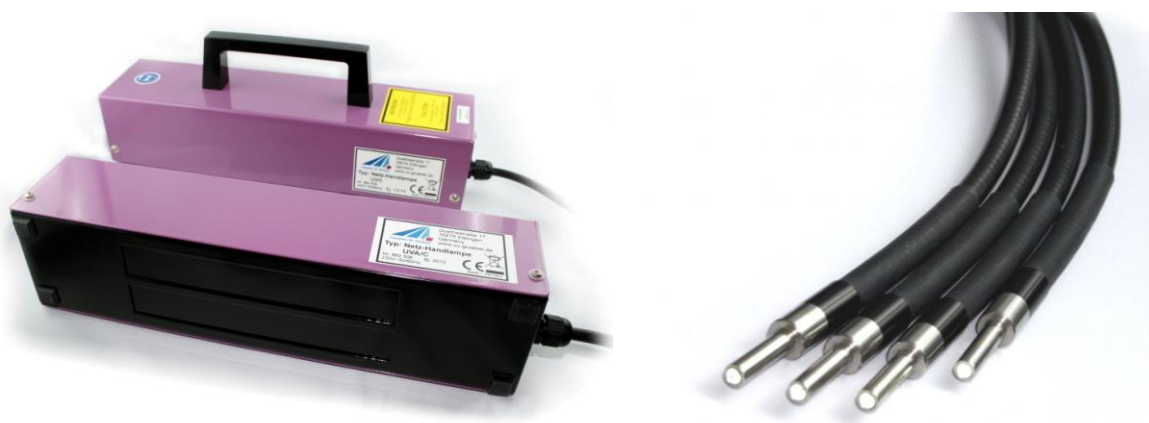
Слика 2: УВ лампа мале снаге за проверу новчаница (а) и усмерена лампа велике снаге за очвршћавање полимера (б) [5]
