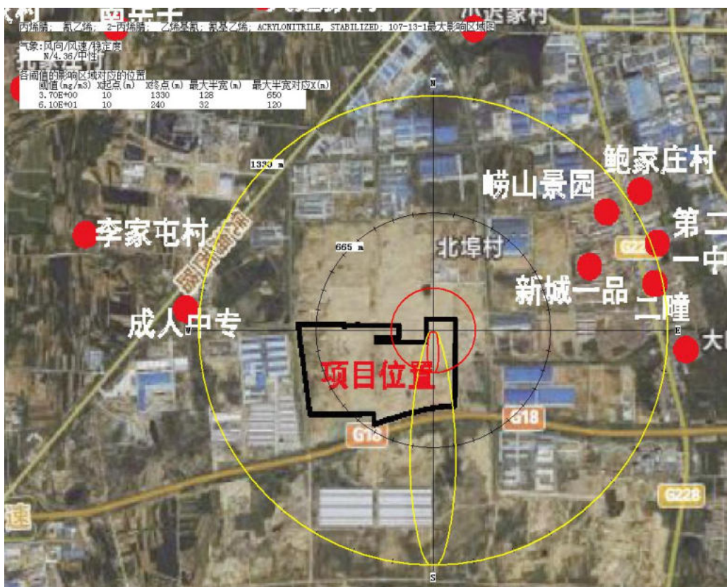
图 4.7-3 最常见气象条件下预测浓度达到不同毒性终点浓度的最大影响范围
