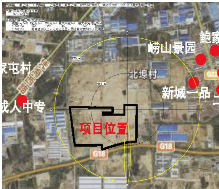
图 4.7-8 最不利气象条件下预测浓度达到不同毒性终点浓度的最大影响范围
