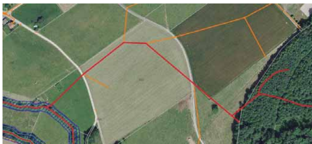
Abb. 45: Eingedolte Fliessgewässer für welche auf die Festlegung eines Gewässerraums verzichtet worden ist. Zizilbach (oben), Riedligrabe (unten links) und Linglisbach (unten/mitte rechts). Genordet und ohne Massstab.
