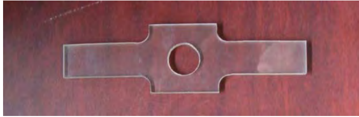
Fig. 1.2 Probeta fotoelástica de sección variable sometida a flexión
