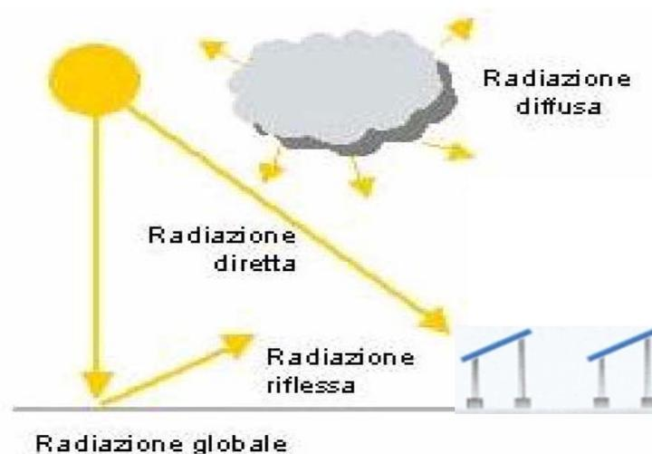
Se chiamiamo  $I_D$  la radiazione diretta,  $I_S$  quella diffusa ed  $R$  l'albedo, allora si ha che la **radiazione solare totale** che incide su una superficie è:
