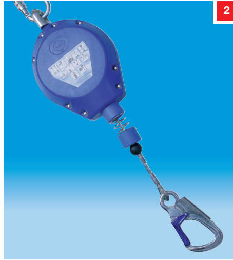
Abb. 2: Das Höhengsicherungsgerät EN 360 wickelt ein Drahtseil automatisch auf und gibt es frei, wenn der Gesicherte sich vom Anschlagpunkt entfernt.
