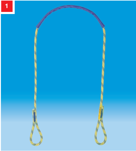
Abb. 1: Anschlagseil EN 795 SK 14, Perlon Kernmantelseil, 14 mm Ø, erleichtert das Befestigen von Sicherheitsseilen z. B. an Kaminen. Kamin umschlingen und den Sicherheitshaken in die beiden Schlaufen einhängen. Standardlänge 2 m. Optional mit Kantenschutzschlauch lieferbar.
