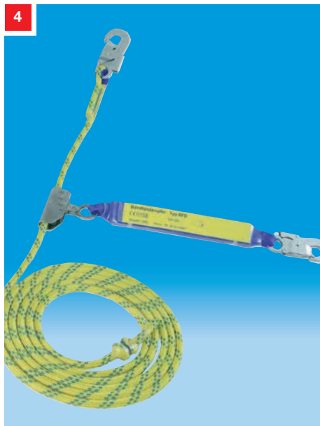
Abb. 4: Seilkürzer mit Bandfalldämpfer, EN 353-2 – Seilkürzer, Material V2 A, mitlaufend an beweglicher Führung. Besonders leicht auf- und abwärts mitlaufend. – Handgerechte Form für einfache Bedienung. Sofortige Arretierung. Für Sicherheitsseil EN 354 SK 12, 12 mm Ø. Verbindungsmittel = Bandfalldämpfer 0,5 m lang, am Seilkürzer angebracht. Bei dem Kernmantelgeflecht ist eine Klankenbildung ausgeschlossen, somit wird eine lange Lebensdauer gewährleistet.
