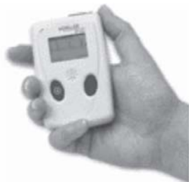
Figura 25. Miniscopio para electrocardiografía (29).
