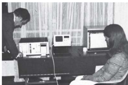
Figura 26. Primer paciente conectado al detector de arritmias (Nielsen Arrhythmia Computer). Se observa además un visoscopio y un inscriptor (30).
