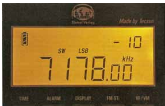
Figur 4: Vid SSB-mottagning kan man ställa in frekvensen hos PL-880 med 10 Hz noggrannhet.
