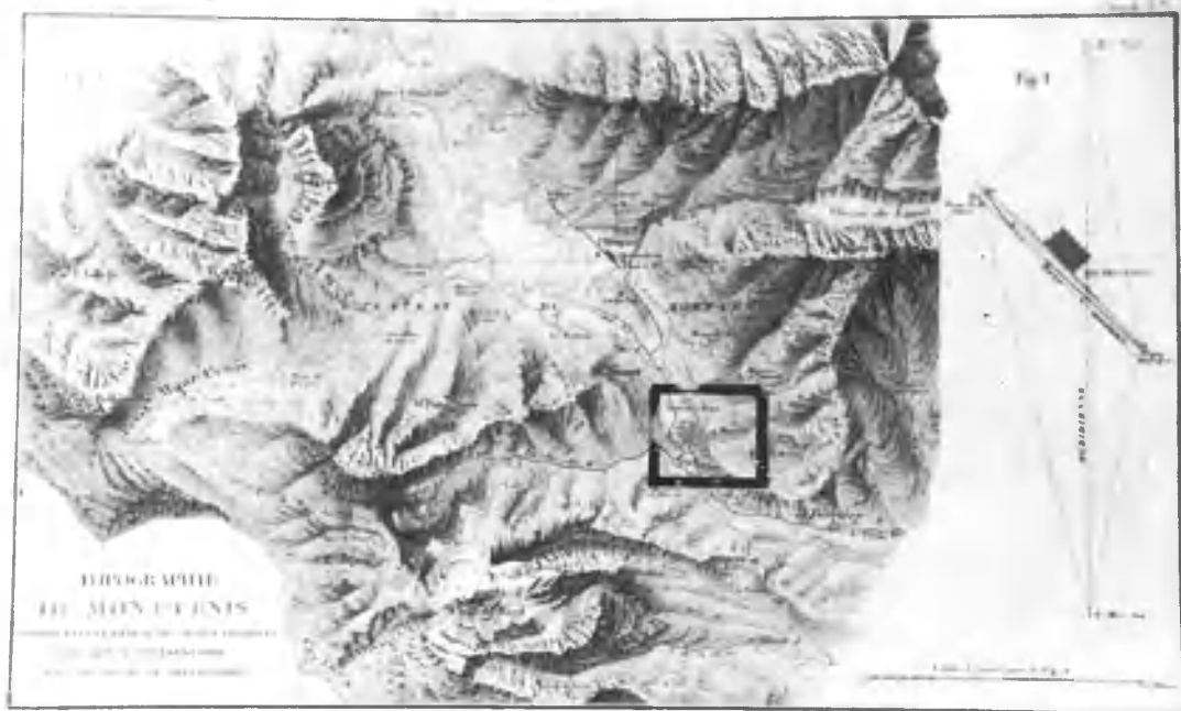
3. "Topographie du Mont-Cenis comprenant le réseau de petits triangles qui lient l'Observatoire avec le signal de Bellecombe" (collezione e riproduzione F. Pari)
