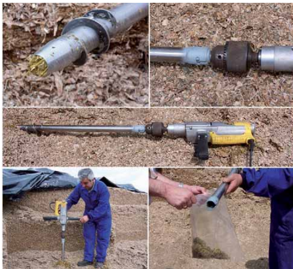
Figura XV.4.- Toma de muestras de ensilados con sonda mecanizada
