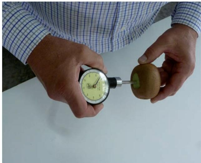
135. Determinación de la dureza del fruto mediante penetrómetro.
