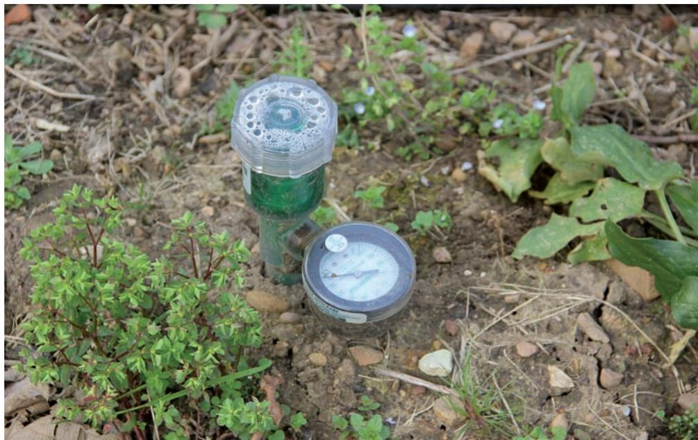
78. Tensiómetro para indicar el estado de humedad del suelo.
