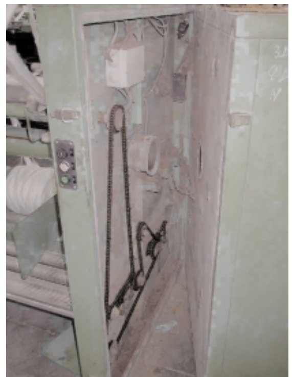
Figura 13 – Particolare del tubo che convoglia gli scarti nella camera di recupero
