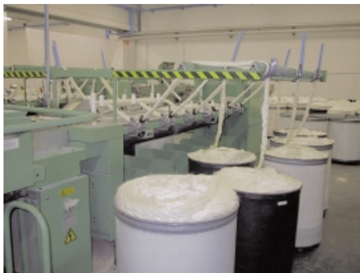
Figura 3 – Alimentazione mediante vasi
