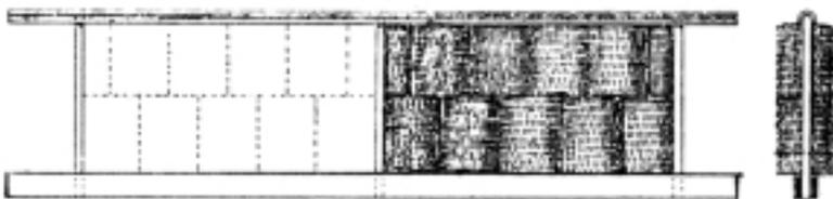
Fig. B - Montaggio dei cardì sui ferri
