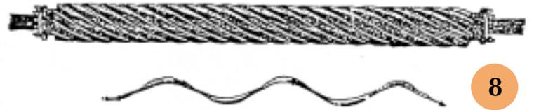
Fig. 8 - Lama elicoidale
