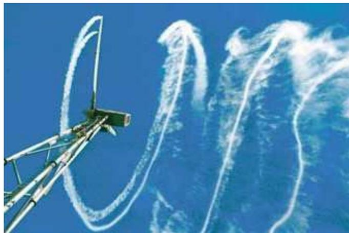
*Efecto estela de un aerogenerador. Parte A.
