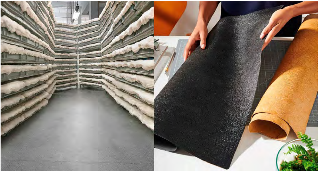
Figura 3. Cámaras de control de temperatura y condiciones ambientales del micelio y resultado final del control en biopiel. Producto e imagen cedidos por Ecovative.
