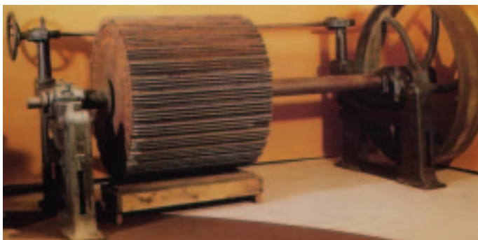
Fig. 2 - Cilindro di legno della "pila olandese" o "pila a cilindro", ricoperto da lame d'acciaio sporgenti
