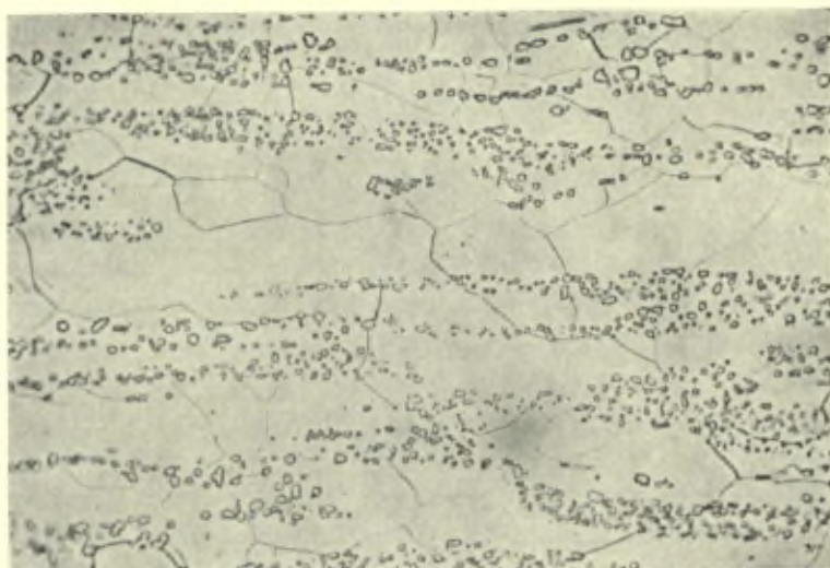
Bild 4a. — Gefüge nach Abschrecken von 715°
