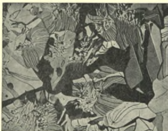
Bild 3. — Oberfläche von rasch erstarrtem, vielkristallinem Zink-Guss, ungeätzt. Lamellarer Aufbau der Kristallite parallel zur hexagonalen Basisebene.
