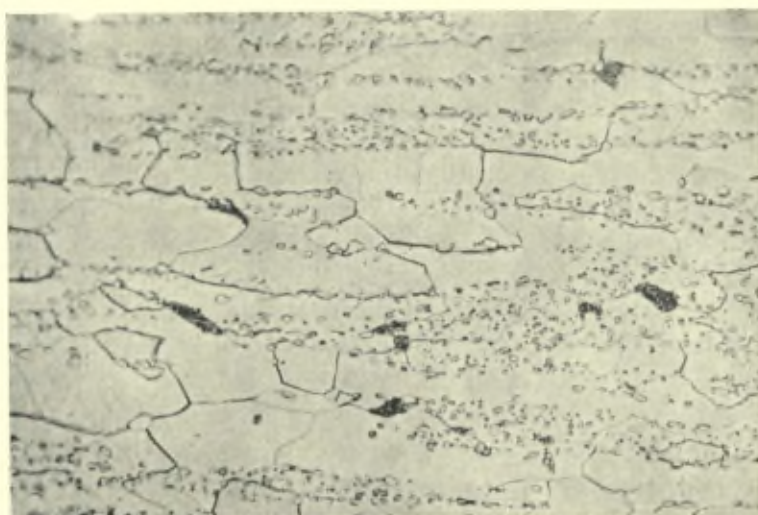
Bild 4b. — Gefüge nach Abschrecken von 822°
