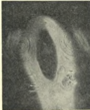
Bild 6. — Seitenansicht der Spitze eines in seiner Schmelze gewachsenen Cu-Dendriten. Lamellenbildung auf den Oktaederebenen, Wachstumsrichtung des Dendriten parallel zur Würfelkante.
