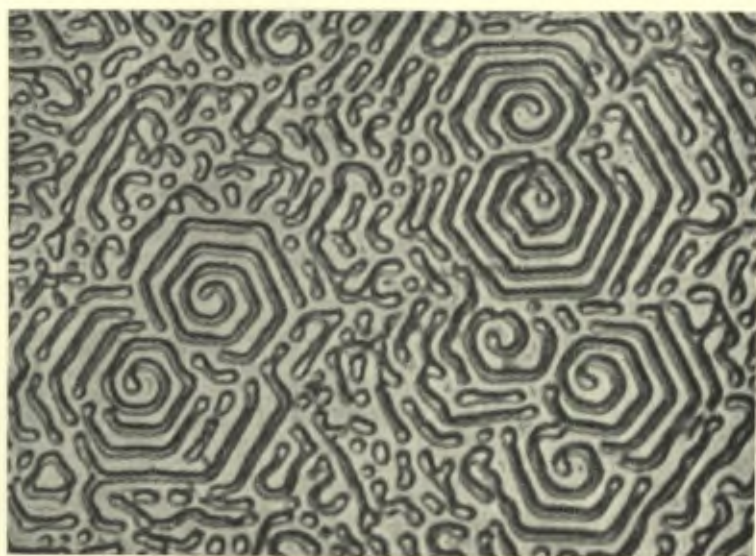
Bild 1. — Eutektikum Zn + 3% Mg
