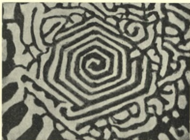
Bild 2. — Eutektikum Zn + 3% Mg
