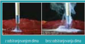
z odstranjevanjem dima brez odstranjevanja dima
