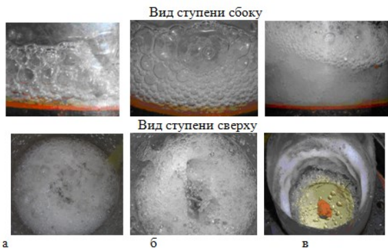
Рис. 1. Режимы газожидкостной смеси на ступени. Режимы: а – пенный; б – кольцевой; в – пленочный. D_c = 114 мм R_s = 44 мм.
