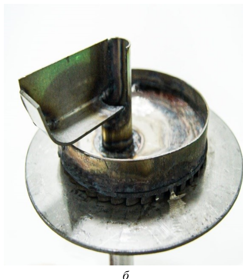
Рис. 1. Схема вихревой колонны термической ректификации а), общий вид ступени б). 1 – тарга; 2 – вихревая ступень; 3 – змеевик; 4 – переточное устройство; \blacktriangleright - вода; \blacktriangleleft - пар; \blacktriangleright - конденсат
