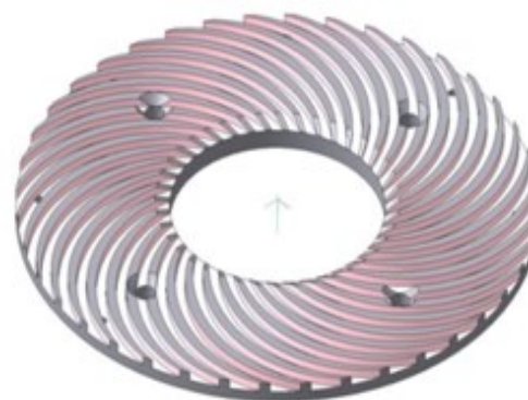
Рис. 2. Размельчающая гарнитура дисковой мельницы с серповидной формой ножей
