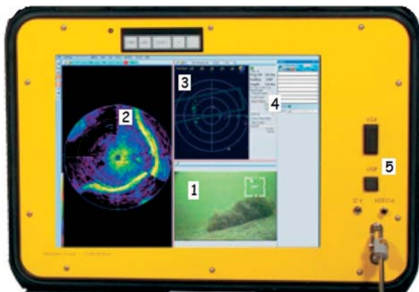
Рис. 4. Пульт управления комплексом «СуперГНОМпро» и окно реального времени управляющей ПЭВМ
