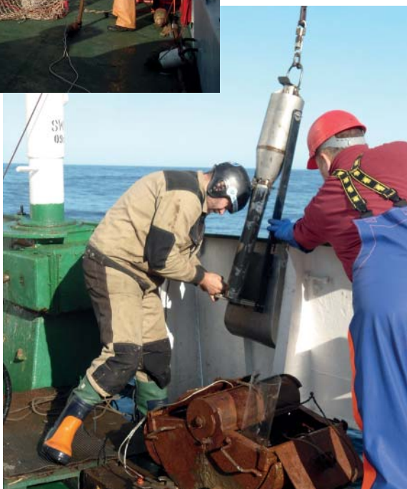
Трубка Неймисто и дночерпатель. Океан – основные орудия от- бора донных осадков
