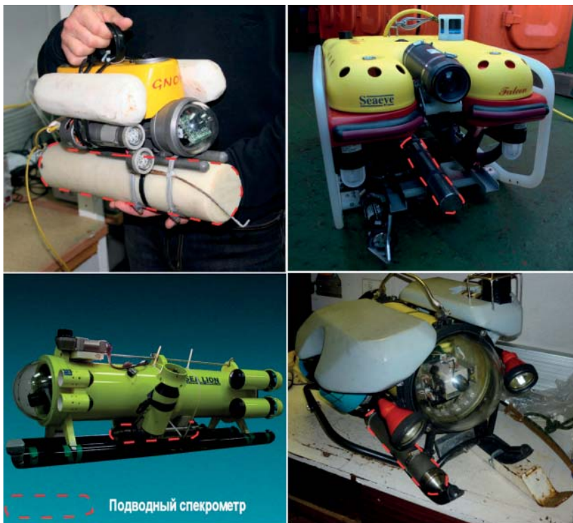
Рис. 1. Размещение подводного спектрометра на ТПА
