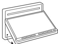
MOTORIZED, SLIDE-DOWN FRONT PANEL
