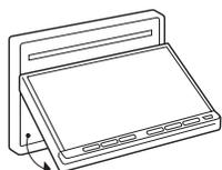
MOTORIZED, SLIDE-DOWN FRONT PANEL
