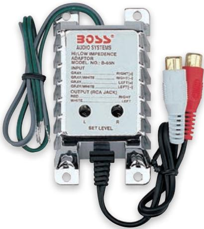
**B65N** HIGH LEVEL TO LOW LEVEL CONVERTER
