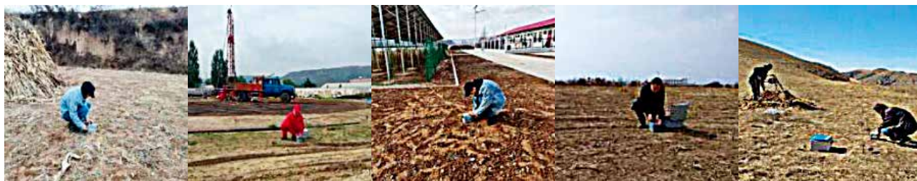
图3 相同场地不同土体含水率条件下土壤电阻率连续实测图
