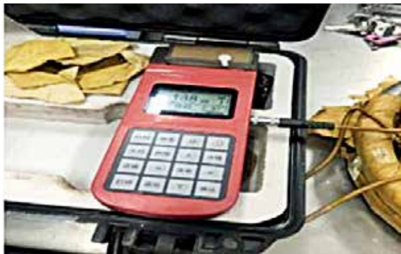
图6 高压垫片材质检测
