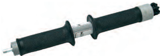
Erdungsgriff VI mit Doppelfunktion Zum Einsetzen der Erdungspatronen in NH- Sicherungsunterteile Zum Anschlieen der E+K-Vorrichtungen VI an Erdungspatronen, GriffLnge 270mm
